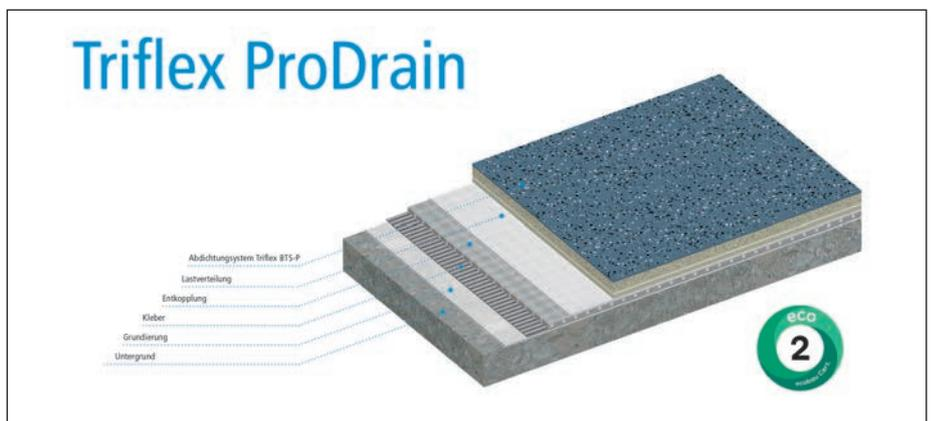
Systemaufbau ProDrain mit Minergie-ECO-Zertifikat eco
