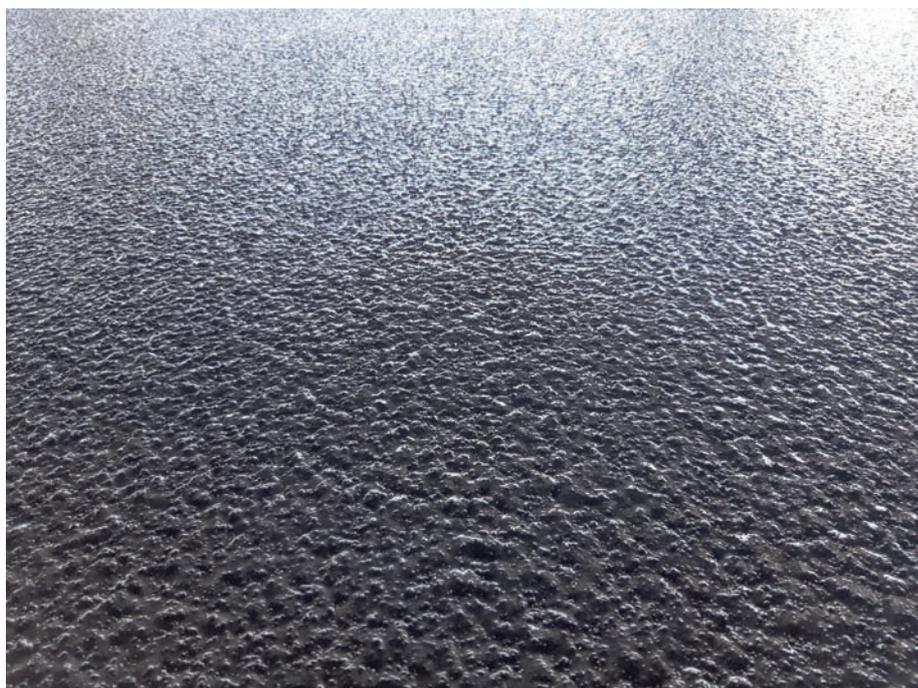
Die Verschleisschicht StoPur AC MultiCoat ist hoch abriebfest. Sie benötigt keine Abstreuung und keine Versiegelung.
