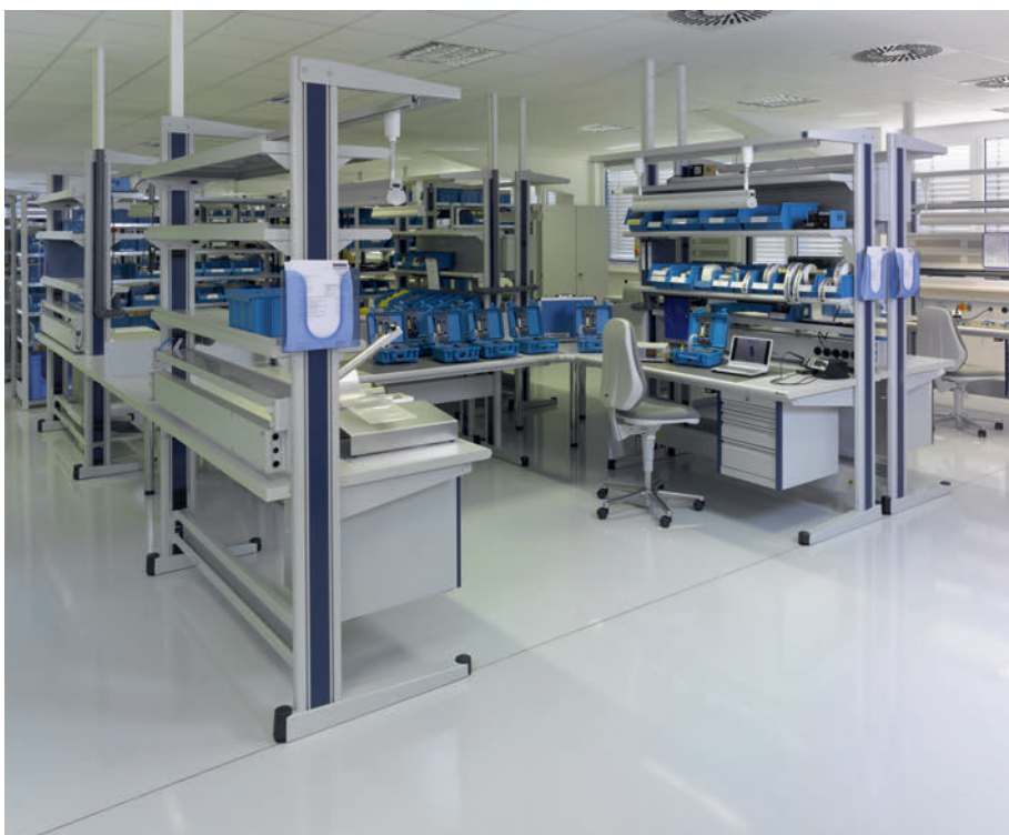
Arbeitsumgebung beim Rauchgas-Analyse-Geräte-Hersteller Systronik in Illmensee. Ein ESD-Boden sorgt hier für Sicherheit: Elektrostatische Aufladung wird zuverlässig abgeleitet.
