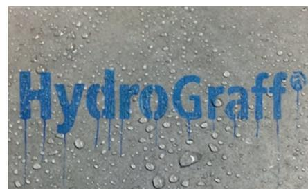
Mit HydroGraff® geschützter Architekturbeton. Unter Architekturbeton versteht man einen Beton, an den architektonisch hohe Anforderungen gestellt werden (z.B. möglichst perfekte, einheitliche Oberfläche)
