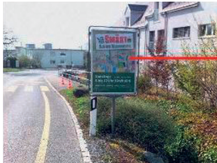
Beispiel von Reklame-Platzierungen bei Fussgängerstreifen, die so nach der neuen Norm nicht mehr zulässig wären, weil sie das Erkennen von anderen Verkehrsteilnehmern erschweren
