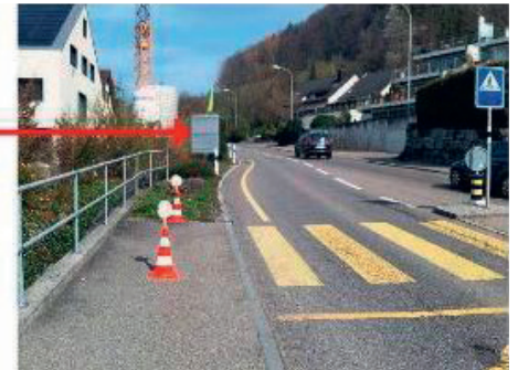
Beispiel von Reklame-Platzierungen bei Fussgängerstreifen, die so nach der neuen Norm nicht mehr zulässig wären, weil sie das Erkennen von anderen Verkehrsteilnehmern erschweren
