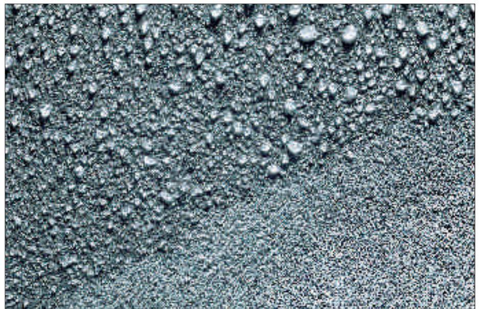
Mineralische Baustoffe sind porös und saugen bei Kontakt mit Wasser Feuchtigkeit auf.
