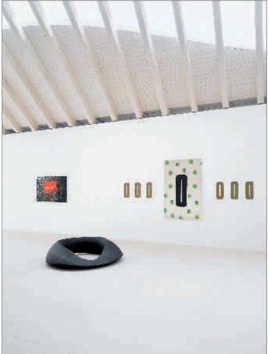
Die Acrylglas-Stegplatten des geschwungenen Daches versorgen die Kunstwerke im Inneren mit ausreichend Licht von zwei Seiten.
