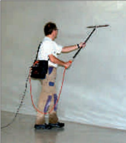
Porensuche mittels Abfunkgerät
