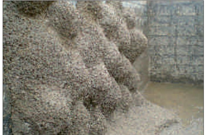
Bild 4: Vollflächiger Gelschleier als Ergebnis einer Zweistufeninjektion mit dem Acrylatgel MC Inject GL 95 in Recyclingsand
