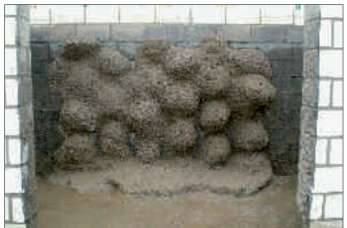
Bild 5: Vergelungsergebnis einer einstufigen Injektion mit dem Acrylatgel MC Inject GL 95 und einem geringen Injektionsdruck in Recyclingsand
