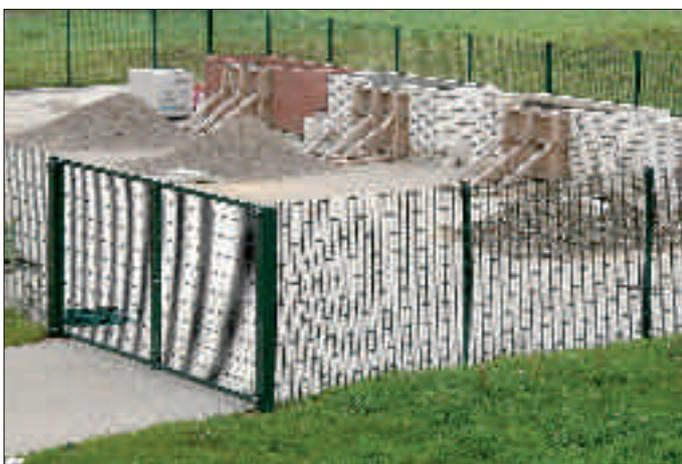
Bild 2: Prüfstände für Vergelungsversuche auf dem Freigelände der Fachhochschule Dortmund
