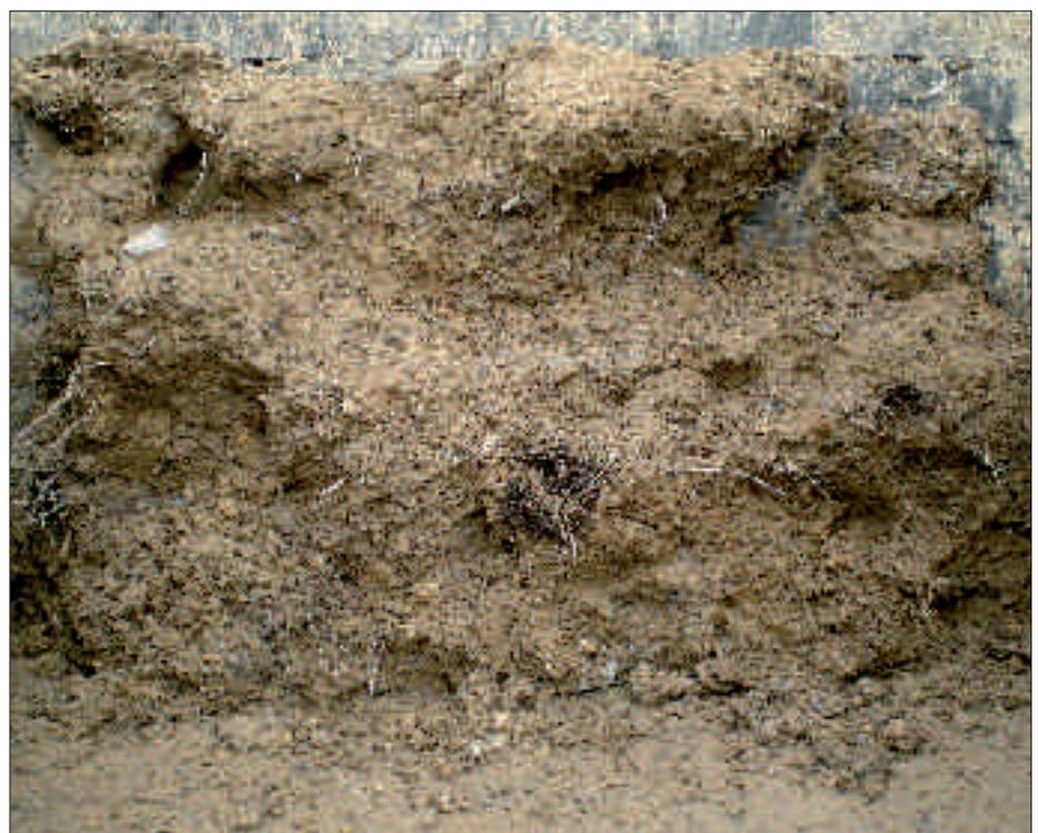
Bild 7: Ergebnis eines Vergelungsversuches bei schluffigem Boden mit dem Acrylatgel MC Injekt GL 95
