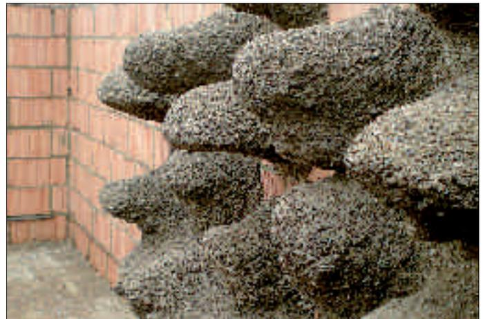
Bild 6: Vergelungsergebnis einer einstufigen Injektion mit dem Acrylatgel MC Injekt GL 95 und einem höheren Injektionsdruck in Recyclingsand
