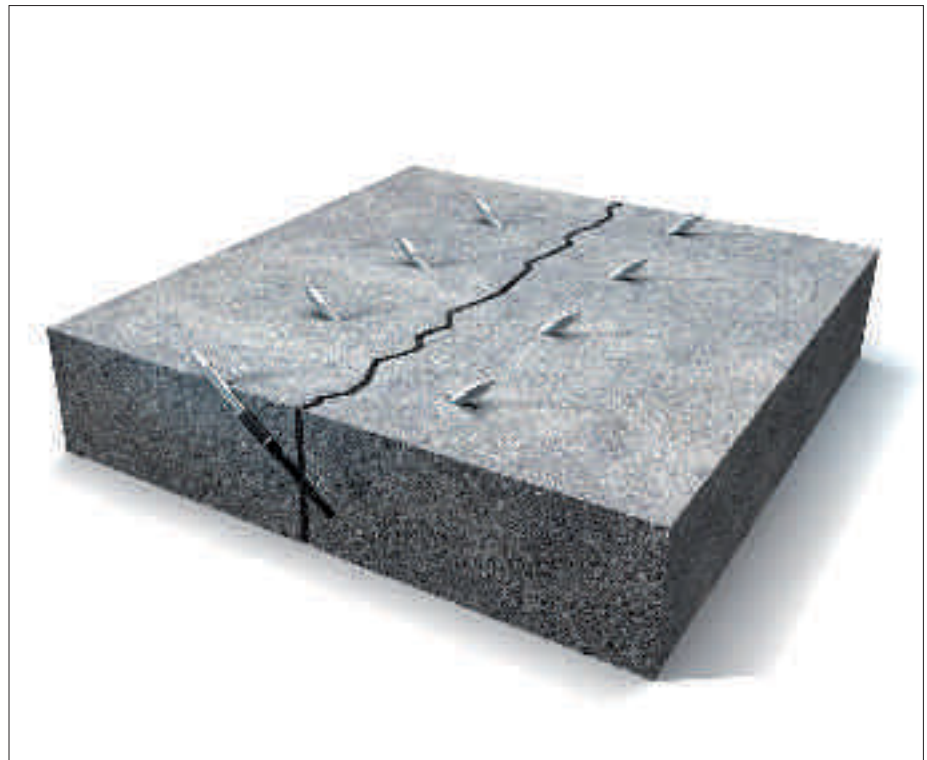
Bild 8: Prinzip der Bohrpackeranordnung nach
