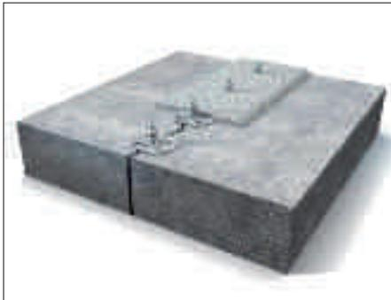
Bild 10: Anordnung von Klebepackern an einem Trennriss
