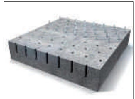
Bild 12: Grundsätzliche Anordnung von Bohrpackern im Raster
