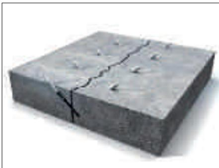
Bild 11: Anordnung von Bohrpackern an einem Trennriss
