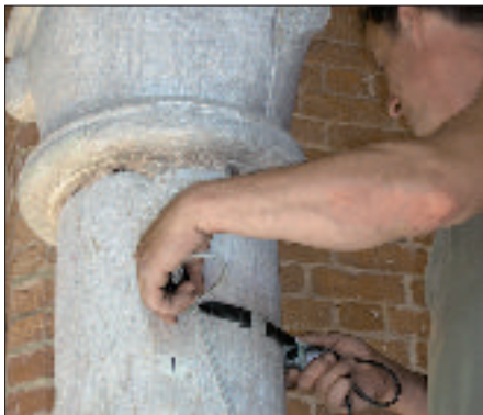
Bild 5: Ultraschallmessanordnung für die tangentielle Säulendurchschallung.
