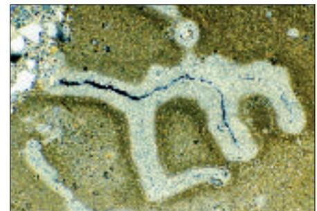
Abb. 8: Durchlichtmikroskopische Aufnahme eines mittelalterlichen Kalkmörtels (Burg Hohenrechberg), gekreuzte Polarisatoren. Untere Bildkante entspricht 1,7 mm
